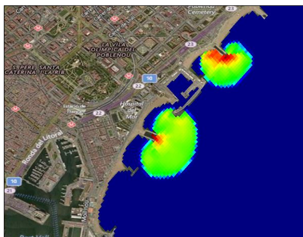
Figura 31. Exemple de simulació de qualitat marítima després d'un episodi de DSU (Vermell= alta concentració d' E. coli ; Blau= baixa concentració d' E. coli ).
