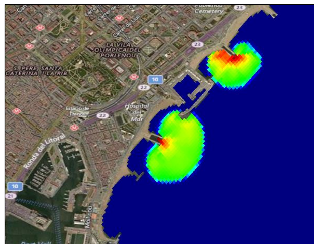
Figura 31. Ejemplo de simulación de calidad marítima después de un episodio de DSU (rojo = alta concentración de E. coli ; azul = baja concentración de E. coli ).
